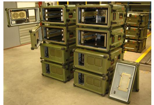
De plus, nous avons conservé les atouts de nos caissons, gardant une structure carbone permettant d'alléger le caisson et de tenir les contraintes mécaniques.
